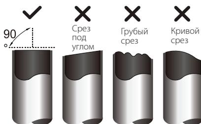
4. Тщательно удалите все заусенцы со среза трубы. Во время удаления заусенцев держите трубу срезом вниз, чтобы стружки и пыль не попали внутрь нее.
