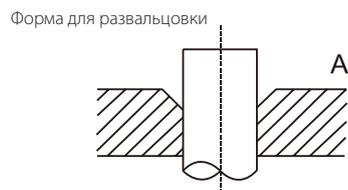
7. Развальцуйте трубу с помощью вальцовок. Снимите вальцовку и форму для вальцовки, осмотрите кромку трубы на предмет трещин и равномерной вальцовки.
