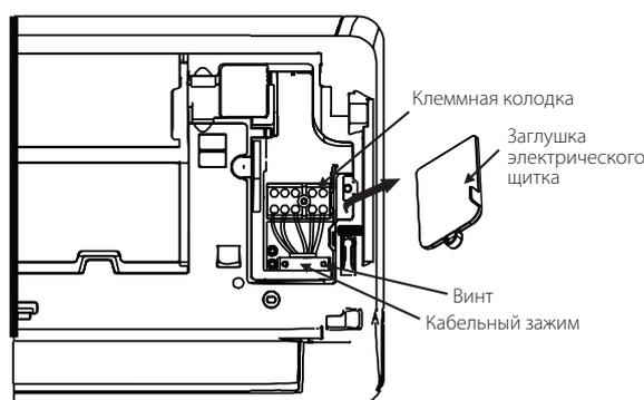
4. Отверните кабельный зажим, расположенный внизу клеммной колодки, и отложите его в сторону.
