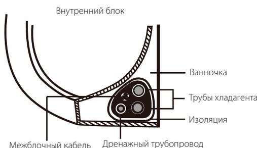
Убедитесь в отсутствии подъемов, перекручиваний и перегибов на всем протяжении дренажного шланга.
