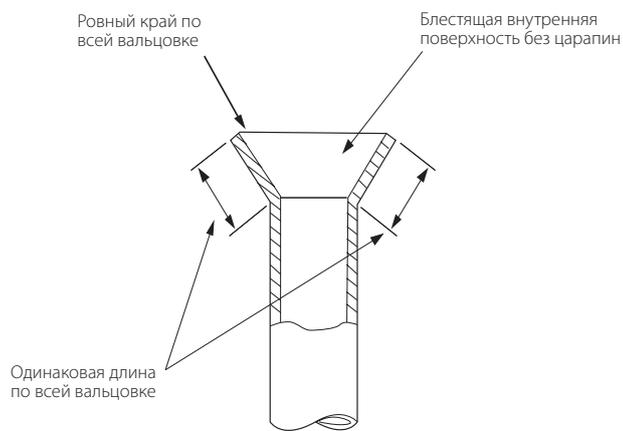
8. Установите развальцованные трубы соосно со штуцером. При подсоединении сначала выровняйте центр, затем затяните конусную гайку на первые 3-4 оборота.
