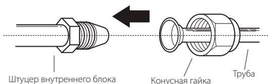
9. Используя динамометрический ключ, затяните конусную гайку. При затяжке ориентируйтесь на значения, приведенные ниже в таблице. Чрезмерная затяжка может повредить развальцованный участок!
